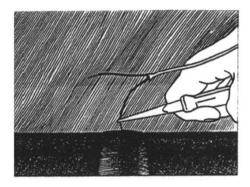
Encoste o fio do termopar na peça de trabalho no ponto em que o termopar é para ser soldado. Não toque na peça de trabalho diretamente com o alicate.
